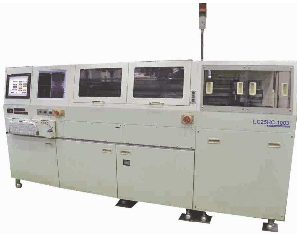
液晶パネル・タッチパネル 外観検査装置
